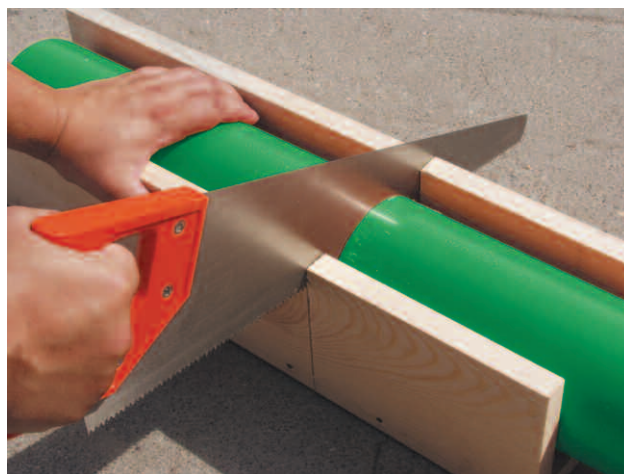
Розрізання труби з використанням столярного навскісника
