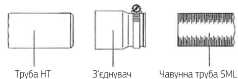
З'єднання з чавунною трубою SML
