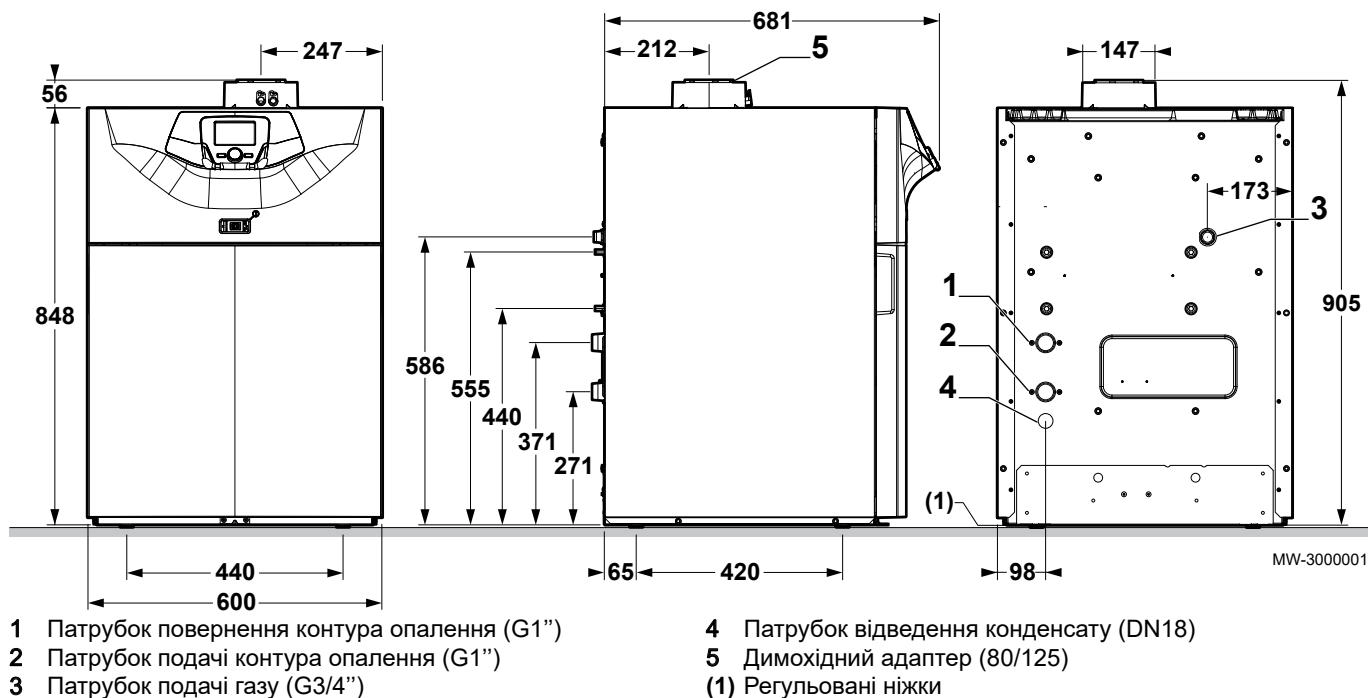
Рис. 3 Розміри та підключення POWER HT+ 1.90 і POWER HT+ 1.110
