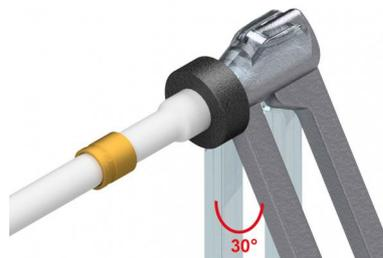
Отрежьте часть трубы, которая имеет неправильную форму после расширения, и выбросьте несоответствующий кусок трубы. Замените расширители, которые повреждены или не дают правильной формы расширяемой трубе. Неисправный расширитель может вызвать проблемы с уплотнением трубы и фитинга. Смажьте конус расширителя, если ход конуса затруднен.
