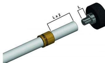
Постепенно и равномерно расширяйте трубу, не нагревая расширяемые части. Рекомендуемая температура во время монтажа от -10°C до 50°C. Примечание: в зависимости от типа трубы используйте соответствующий расширитель.
