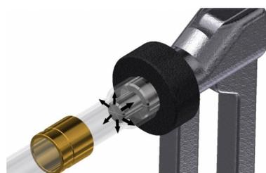
Процесс расширения необходимо повторить второй раз, повернув инструмент на 30°. Если внутренняя часть трубы не имеет ровную цилиндрическую форму, повторите описанные выше действия еще раз.
