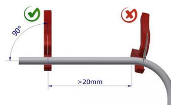
Убедитесь, что расширитель не поврежден и что он закручен до упора. После завинчивания, расширитель не должен откручиваться при вращении трубы на расширителе. Убедитесь, что используемый инструмент подходит для типа трубы, которую собираетесь монтировать. Вставьте расширитель без усилий параллельно оси трубы.
